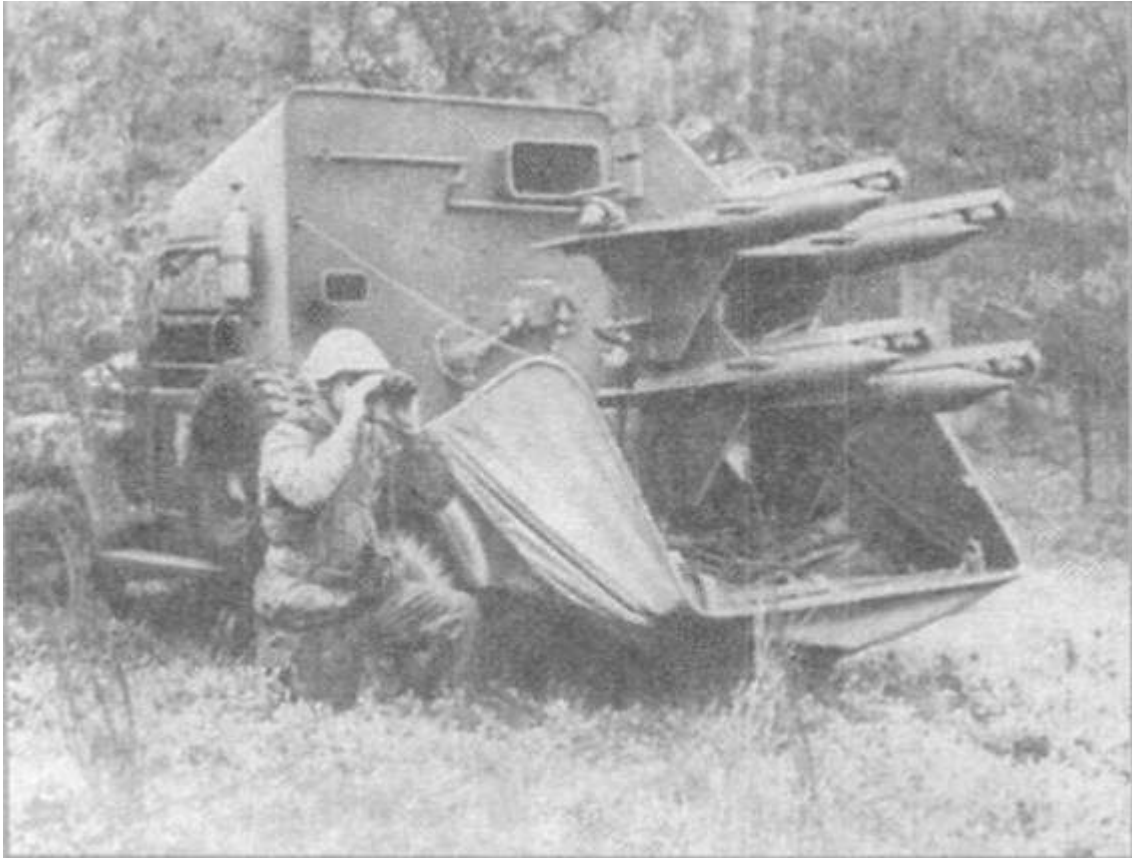
Противотанковый ракетный комплекс 2К15 «Шмель» на базе автомобиля ГАЗ-69
