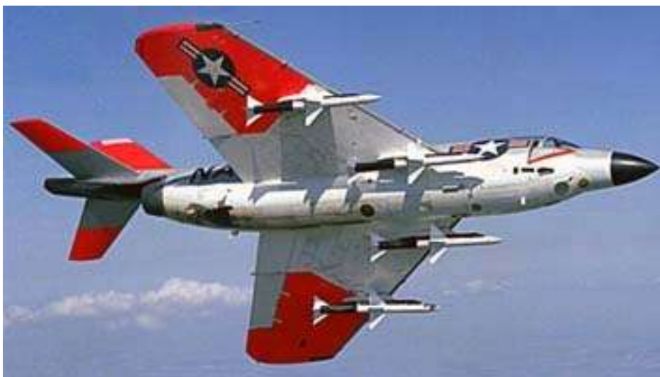
Палубный истребитель-перехватчик US NAVY F-3B Demon с 4 УР AIM-7C
