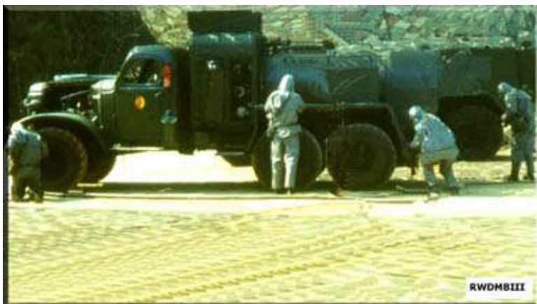
заправщики окислителя 8Г17 технической батареи комплекса 9К72
